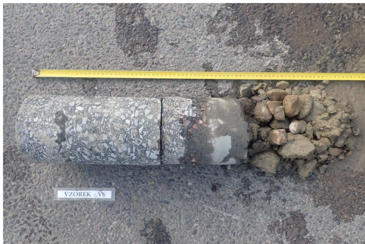
Obr. 11 - Jádru vývrtu Vzorek – V6 (in situ).
