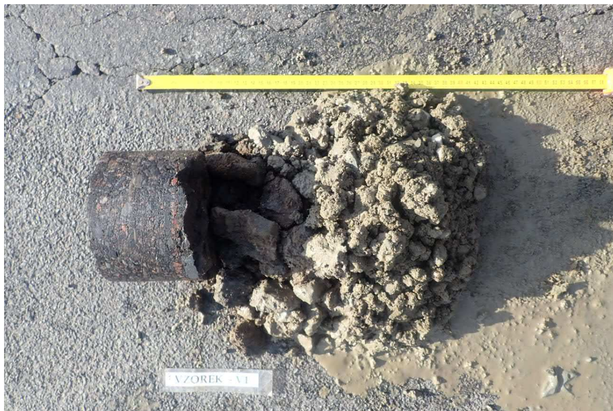
Obr. 1 - Jádro výtvr Vzorek – V1 (in situ).
