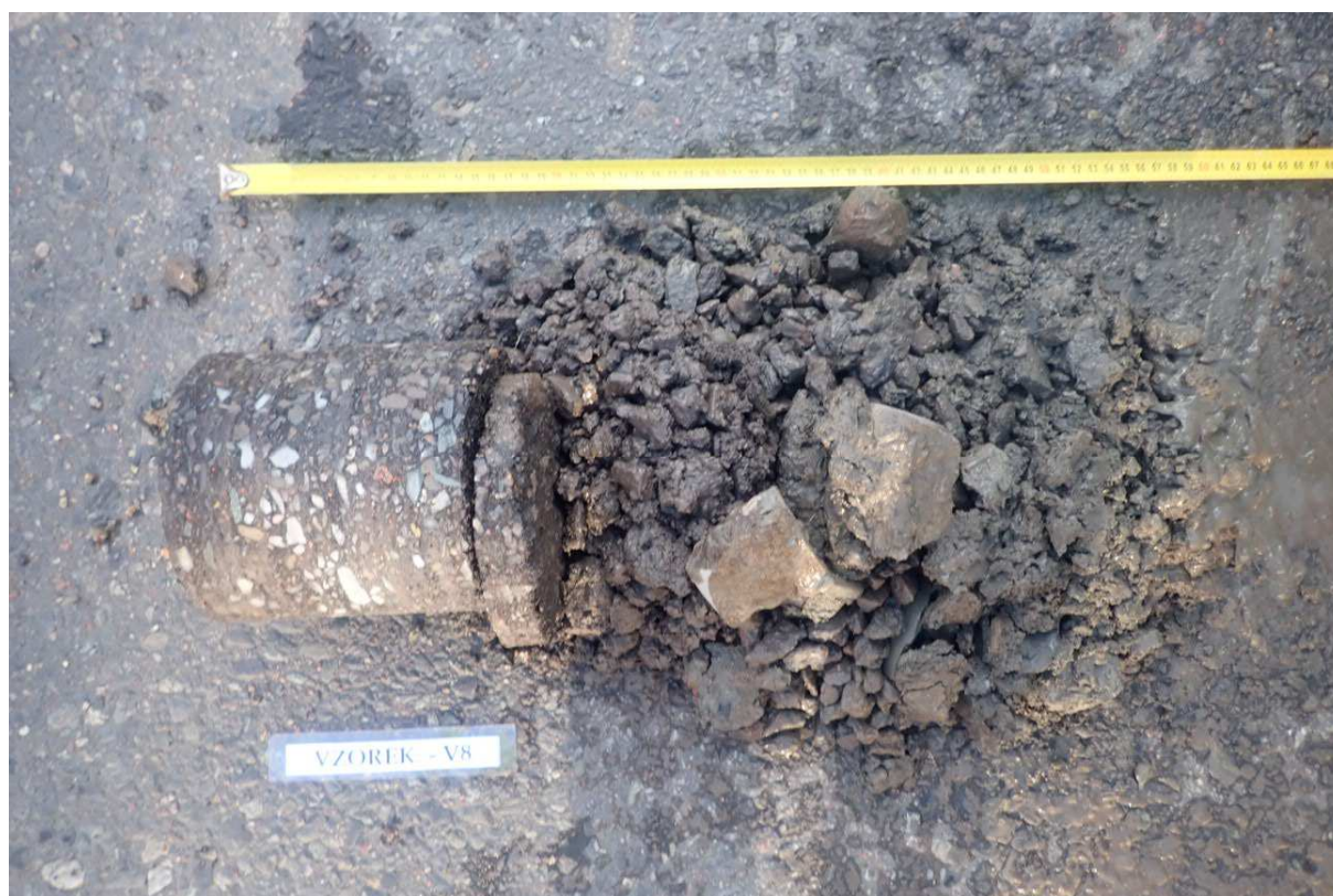
Obr. 15 - Jádru vývrtu Vzorek – V8 (in situ).
