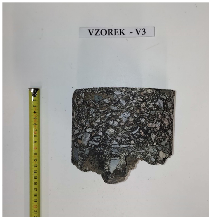
Obr. 6 - Jádru vývrtnu Vzorek – V3 (laboratoř).
