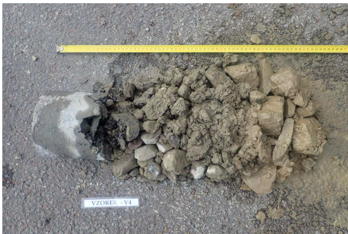
Obr. 7 - Jádro vývrtu Vzorek – V4 (in situ).
