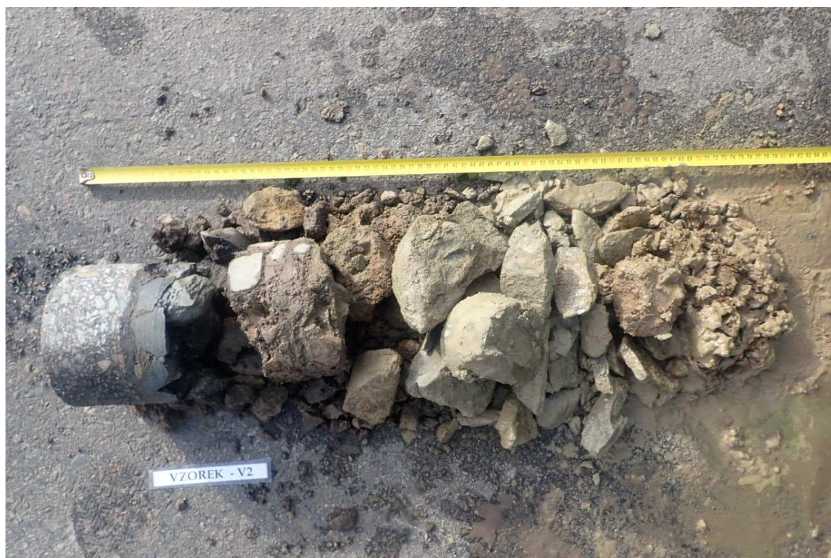
Obr. 3 - Jádro výtvetu Vzorek – V2 (in situ).
