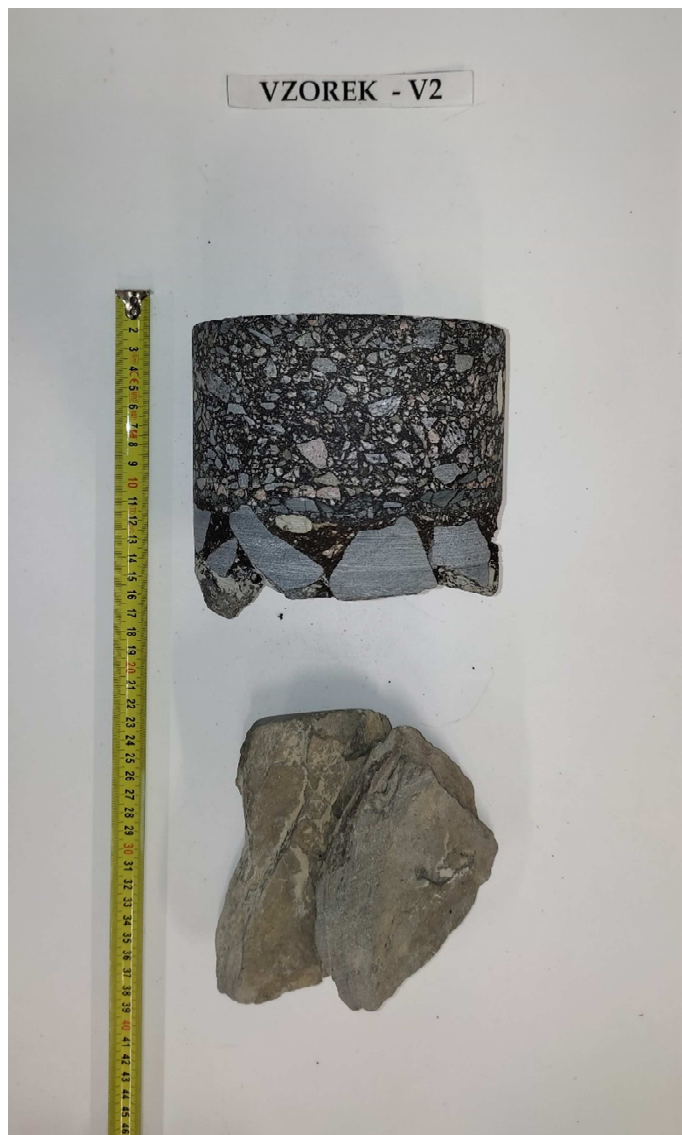
Obr. 4 - Jádru vývrtu Vzorek – V2 (laboratoř).
